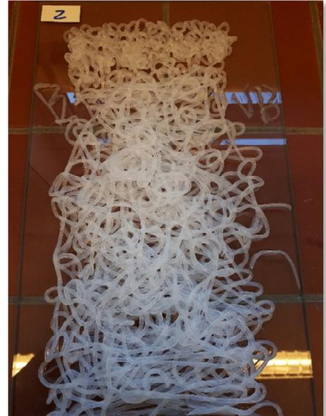
Zur Eluatherstellung wurde die Dichtmasse mittels Handdruckpresse auf eine inerte Glasoberfläche appliziert und unter konstanten Laborbedingung ( $20 \pm 2$  °C) über einen Zeitraum von 7 Tagen Aushärtezeit ruhen gelassen. An den aus exakten Einwaagen des ausreagierten Materials erhaltenen Eluaten waren die im Folgenden benannten ökotoxikologischen Prüfungen durchzuführen:
